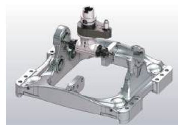
CABEÇOTE FIXO COM MANDRIS OPOSTOS
