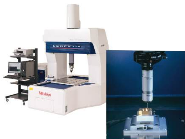
Máquina tridimensional Mitutoyo Legex 776.
